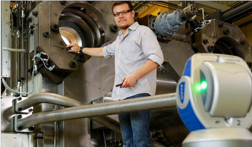
Beim Aufbau der großen Maschinen ist der Laser Tracker nahezu unerlässlich geworden.
